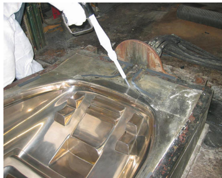
Nettoyage d'un moule
