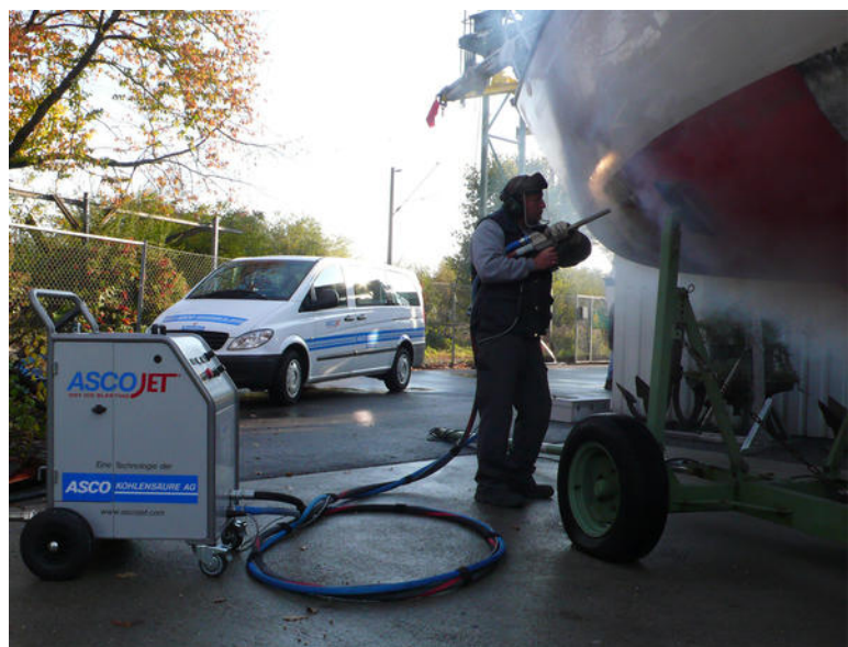
Nettoyage cryogénique sur coque de bateau
