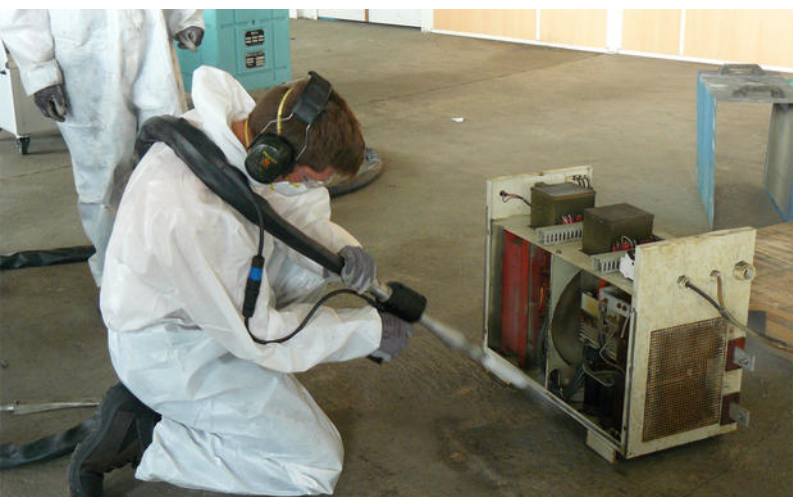
Nettoyage cryogénique sur un condensateur
